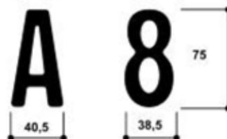
2.2.3 verkleinerte Mittelschrift 49 mm (nur für verkleinerte zweizeilige Kennzeichen und Kraftradkennzeichen)
